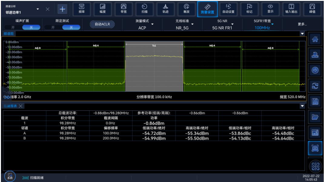
2GHz 载波 5G NR ACPR 实测结果
